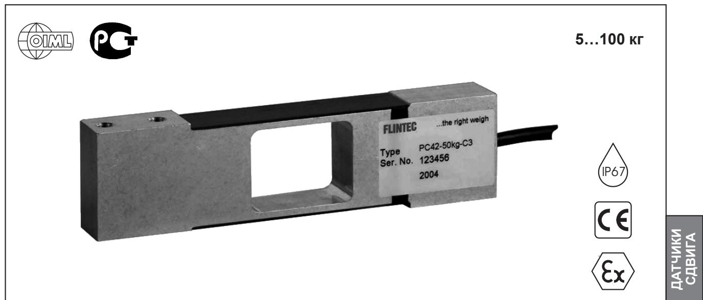
Тензометрический датчик на сдвиг серии PC42 технологии SINGLE POINT минимизирует действие паразитных нагрузок и боковых смещений. Датчик изготовлен из алюминия. Полимерная заливка измерительных элементов обеспечивает высокий класс защиты (IP67).
